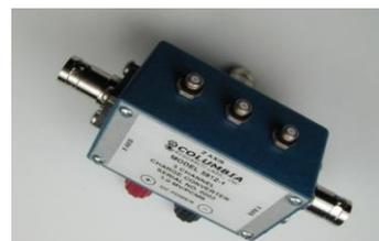
L'alimentation est commune au travers de deux fiches. Ces modèles existent avec des gains fixés en usine. Les modèles **5810** et **5812** possèdent des gains fixés en usine soit : 0,1, 1.0 ou 10.0 mV/pC.
