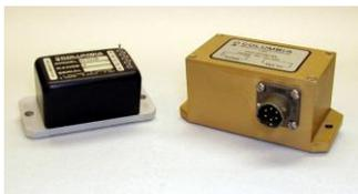
Les instruments de la **Série SI-701** sont des inclinomètres basés sur la technologie des accéléromètres à balance de force. Il donne une sortie basse impédance haut niveau proportionnelle au sinus de l'angle. Le modèle **SI-701B** est une version bas prix qui peut être améliorée avec le système HP (**SI-701BHP**) pour de meilleure précision et robustesse.
