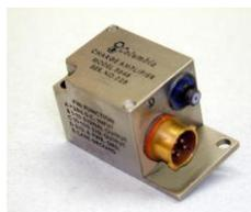
Le modèle **5648-X** est un instrument d'alimentation et de conditionnement monovoie robuste offrant une interface à gain unitaire entre des capteurs Columbia 8000 ou 9000 ainsi que tous les capteurs à électronique intégrée du marché qu'ils soient capteurs de vibrations, pressions ou forces. Le **5648-X** fournit une source courant constant de précision 4,0mA au circuit conditionneur pour un capteur choisi. Il offre aussi un filtre passe bas 2 pôles 12dB/Octave et une faible impédance.
