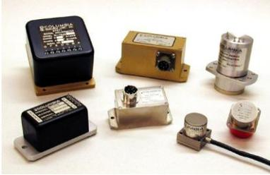
Columbia fabrique une large gamme d'accéléromètres linéaires comme le modèle faible coût usage général **SA-107B**, qui existe en versions un axe et trois axes et peut être surclassé avec le système breveté HP qui améliore précision et fidélité. Le modèle **SA-107LN** est un instrument ultra faible bruit haute tension de sortie pour des mesures de faibles niveaux comme les mesures sismiques.
