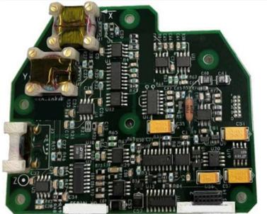
Le modèle 115 est petit sous forme de circuit imprimé, il mesure les faibles champs magnétiques (0,02 milliGauss à 0,65 Gauss). La sortie est sous forme de 3 signaux analogiques
