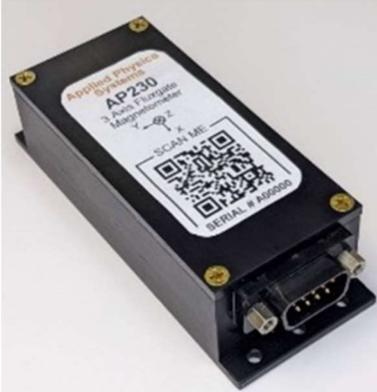
Le modèle AP230 est une version simplifiée du modèle 539 dédié à la recherche et aux universités. C'est un magnétomètre haute vitesse 3 axes à porte de flux qui peut aussi mesurer sa vitesse de rotation.
