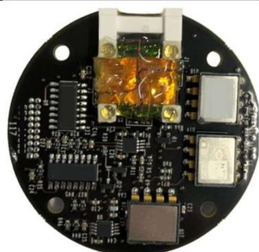
Le modèle 117 donne des informations de direction avec une précision meilleure que 0,1° angulaire. C'est une version du modèle 117 intégrant 3 accéléromètres de précision pour fournir roulis, tangage et cap à 0,1° angulaire près. Il dispose de 3 sorties analogiques.
