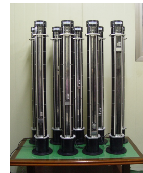
Capteur de hauteur de neige ignorant les particules Flocons en suspension etc ...
