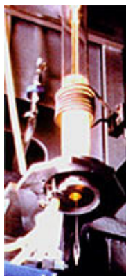
Fibre optique venant de la préforme.
