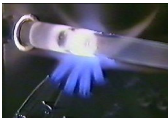
Fabrication de la préforme.
